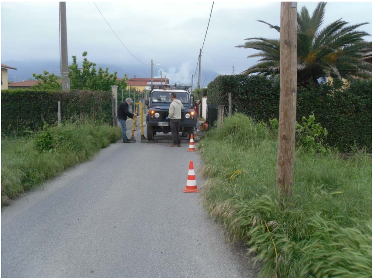
Foto n.1 Energizzazione con il pendolo per la produzione di onde SH (colpo centrale C).
